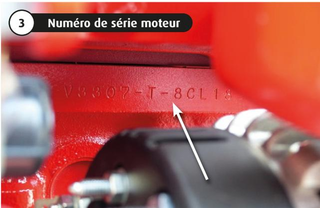
Le numéro de série du moteur est également estampé sur le bloc-moteur aux emplacements suivants.
