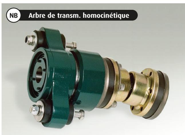
**NB :** si vous envisagez de monter un arbre de transmission homocinétique, il peut être nécessaire de remplacer le plateau d'entraînement du moteur fourni en standard pour éviter des vibrations torsionnelles problématiques. Contacter Beta Marine pour recevoir des conseils techniques.
