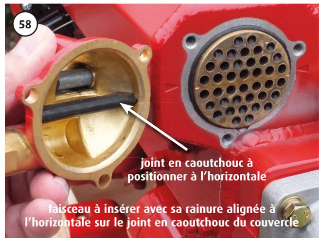
\*NB : sur les moteurs à turbocompresseur **Beta 70T, 85T, 90T, 105T et 115T**, l'anode est fixée sur une vis insérée dans le couvercle de l'extrémité avant de l'échangeur. De plus, le faisceau de tubes doit être sorti et remis en place par l'avant de l'échangeur. Voir images 59 et 60.
