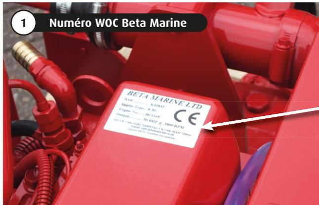
L'étiquette des caractéristiques moteur, située sur le cache-culbuteurs, indique le n° WOC, le type et le n° de série du moteur et sa puissance en ch (« bhp »).
