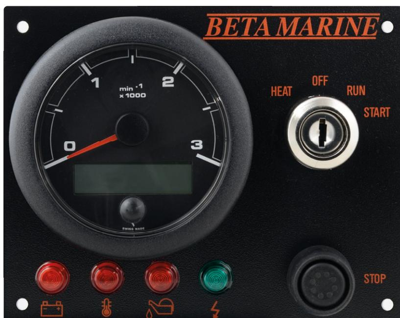
1. Mettre le ou les coupe-circuit batterie sur ON et la clé de contact sur marche (**RUN**). Les voyants du tableau de bord devraient s'allumer comme suit.
